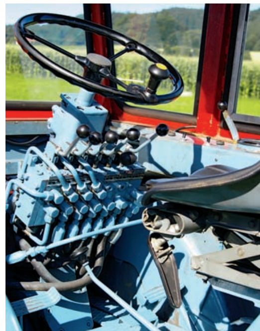
Rückwärtsfahrer: Bedienhebel der Hydraulik des SR 2 mit Dreizylindermotor
