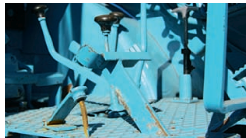
Nach Richtungswechsel kein Umdenken nötig: über Kreuz angeordnete Pedale des SR 3
